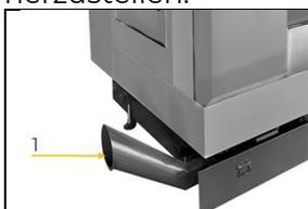
Trichter des Späneförderers (1) wie abgebildet montieren
