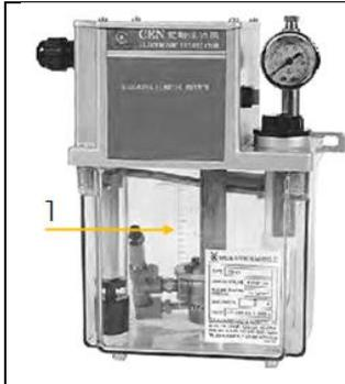
Überprüfen Sie jeweils vor Arbeitsbeginn bzw. nach jeder Wartung und Instandsetzung den Ölstand der Zentralschmierung. Der Ölstand muss sich im Bereich der Skala (1) befinden.
